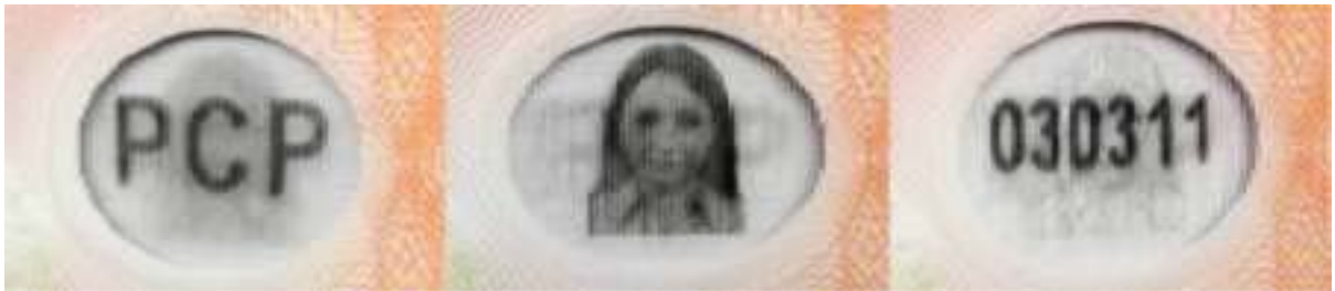
Rys. 3. CLI umieszczony w transparentnym okienku - obrazy widoczne pod różnymi kątami.
